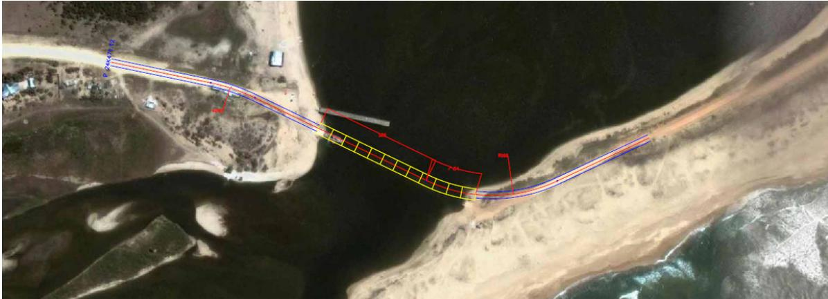
Los tramos de accesos tendrán un ancho de calzada de 7,20 m (carriles de 3,60 m) y banquetas de 2,40 m de ancho. Pevio al puente se implantarán flex beam en ambos lados como dispositivos de seguridad, en una longitud de 70 m del lado de Maldonado y 140 m del lado de Rocha.
